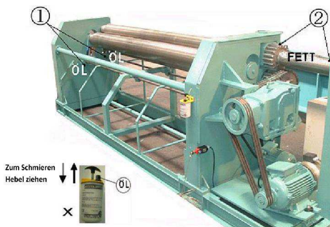
Fig. 27: Puntos que se deben lubricar en la máquina curvadora
